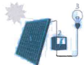
1. Zonnepaneel | 2. Omvormer | 3. Elektrische toestellen
