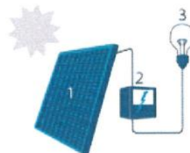
1. Zonnepaneel | 2. Omvormer 3. Elektrische toestellen
