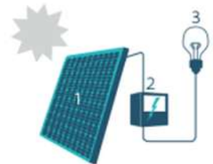
1. Zonnepaneel | 2. Omvormer | 3. Elektrische toestellen
