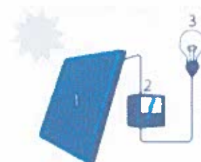
1. Zonnepaneel | 2. Inverter | 3. Elektrische toestellen
