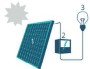
1. Zonnepaneel | 2. Omvormer | 3. Elektrische toestellen
