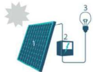
1. Zonnepaneel | 2. Omvormer | 3. Elektrische toestellen
